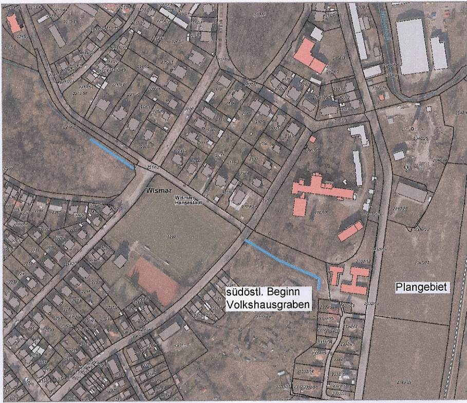
Externe Ausgleichsmaßnahme „A extern“ – Renaturierung eines Teilabschnittes (blaue Lagerdarstellung) des Volkshausgrabens (Quelle: Luftbild GeoBasis DE/M-V 2016)
